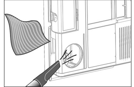
11. Mit einem Staubsauger oder einem weichen Tuch den Schmutz aus beiden Kanälen entfernen (kein Wasser verwenden).
