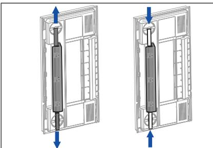
4. Die beiden verschmutzten Zufuhrfilter über die Ober- und Unterseite des Filtergehäuses entfernen.
