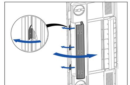
3. Zufuhrfilter. Die drei Verschlussklammern an der Oberseite öffnen und das Filtergehäuse nach vorne kippen.
