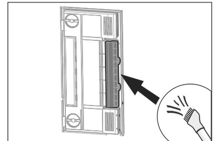
6. Reinigen Abfuhr. Wenn die Filter noch nicht gründlich gereinigt werden müssen, können Sie diese mit einem Staubsauger reinigen. Dafür müssen Sie das Filtergehäuse nicht öffnen.
