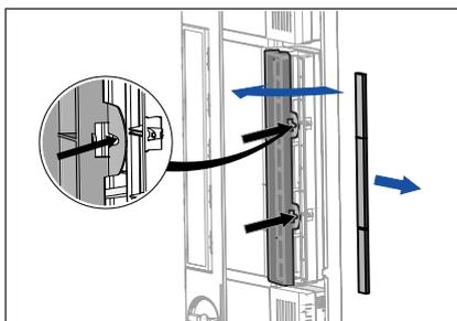
7. Wechseln der Abfuhrfilter. Das Filtergehäuse entriegeln, indem Sie die beiden Verschlussklammern vorsichtig in Ihre Richtung ziehen. Das Filtergehäuse so weit wie möglich nach vorne drehen. Den Filter an der Vorderseite aus dem Filtergehäuse herauschieben.
