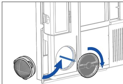
12. Die runden Einsätze wiedereinsetzen. Die beiden Inspektionsluken wiedereinsetzen und gut verschließen, damit das Gerät ordnungsgemäß funktioniert.
