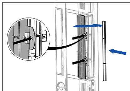
8. Die drei neuen Filter in die Fächer einsetzen und das Gitter an der Unterseite mit den zwei Verschlussklammern kräftig festdrücken, bis Sie ein Klicken wahrnehmen. Vorsicht: um ordnungsgemäß zu funktionieren, muss das Filtergehäuse fest montiert sein.
