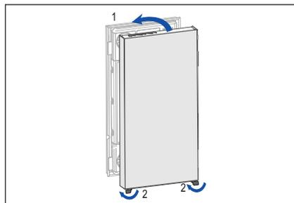
13. Die Abdeckung wiedereinsetzen und die Verriegelungshaken schließen (an der Unterseite oder den Seiten des Gehäuses).
