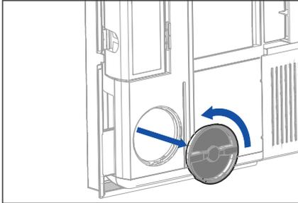
9. Reinigen der Luftkanäle. Die beiden Inspektionsluken nach links drehen und entfernen.
