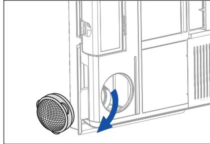
10. Die runden Einsätze aus dem Luftkanal entfernen und Staub und Schmutz aus dem Insektengitter entfernen.
