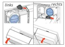
7. Setzen Sie die beiden schwarzen Filterkappen (links und rechts) wieder auf und schließen Sie die Klappen wieder.
