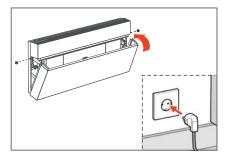
9. Klappen Sie das untere Gehäuse wieder zurück und befestigen Sie dieses mit den Schrauben. Stecken Sie anschließend den Stecker wieder in die Steckdose.
