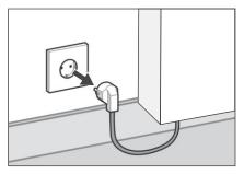
1. Schalten sie das Gerät zunächst aus, indem Sie den Stecker aus der Steckdose ziehen.
