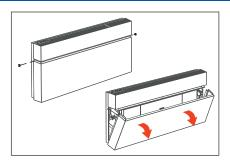
2. Schrauben Sie die Verriegelungsschrauben aus dem Gehäuse. Das untere Gehäuse kippt jetzt nach vorne.
