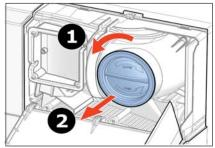
5. Die beiden blauen Kappen eine Umdrehung entgegen dem Uhrzeigersinn drehen und entfernen.
