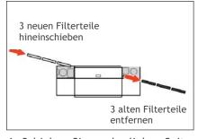
6. Schieben Sie an der linken Seite drei neue Filterteile in das Gerät. An der rechten Seite werden die alten Filterteile automatisch herausgeschoben.
