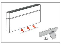
2. Die Abfuhrfilter (3 Stück) befinden sich unten in der Mitte des Gerätes. Diese können entfernt werden, indem Sie einen Finger hinter die Aussparung stecken.
