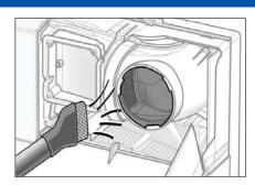
6. Verschmutzung aus beiden Kanälen mit dem Staubsauger oder einem weichen Tuch (kein Wasser verwenden) entfernen.
