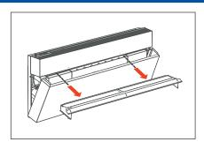
3. Entfernen Sie den Luftverteiler.
