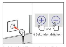
9. Schließen Sie das Gerät wieder an die Stromversorgung an und setzen Sie den Filterstundenzähler zurück (6 Sek. lang gleichzeitig auf + und - drücken). Die Meldung ,Filter vervuild' erlischt jetzt.
