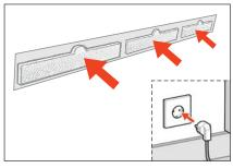
3. Schieben Sie 3 neue Filter in die Halterungen und stecken Sie den Stecker wieder in die Steckdose.
