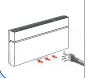
Die Luftabfuhrfilter befinden sich an der Unterseite des Gerätes. Reinigen Sie die Filter mit dem Staubsauger, wenn die Verschmutzung deutlich zu sehen ist. Dadurch bleibt der Luftdurchlass gewährleistet. Dabei ist es nicht erforderlich, die Luftabfuhrfilter herauszunehmen.
