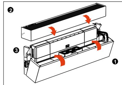
8. Setzen Sie den Luftverteiler wieder an seine Stelle (1), klappen Sie das untere Gehäuse wieder zurück (2) und befestigen Sie dieses mit den Schrauben (3).
