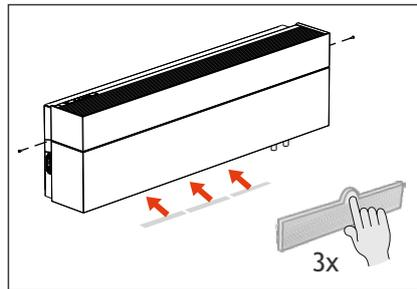
2. Die Abfuhrfilter (3 Stück) befinden sich unten in der Mitte des Geräts. Diese können entfernt werden, indem Sie einen Finger hinter die Aussparung stecken.
