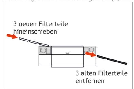
6. Schieben Sie an der linken Seite drei neue Filterteile in das Gerät. An der rechten Seite werden die alten Filterteile automatisch herausgeschoben.
