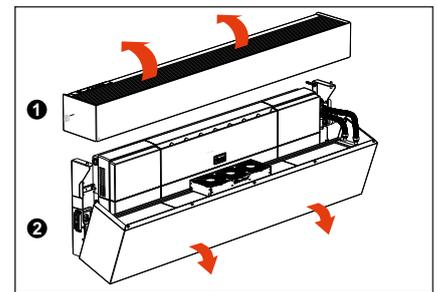
3. Lösen Sie die Feststellschrauben (1), um die obere Kappe von der Unit zu entfernen. Ziehen Sie das untere Gehäuse nach vorne (Hinweis: dieses wurde mit Magneten befestigt). Setzen Sie das Gehäuse in die dafür vorgesehenen Halterungen ein (2).
