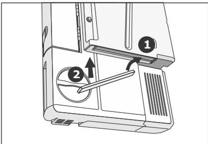
4. Den neuen Filter mit der rechten Seite zuerst in die Abfuhröffnung einsetzen. Danach
