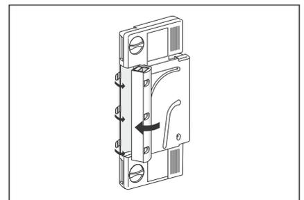
6. Das Filtergehäuse verschließen und mit den drei Verschlussklappen befestigen.
