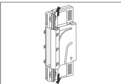
4. Die beiden verschmutzten Filterteile über die Ober- und Unterseite des Filtergehäuses entfernen.
