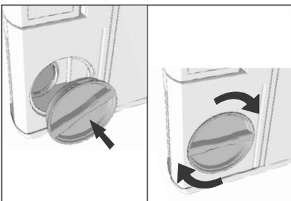
7. Die beiden Stopfen wiedereinsetzen und gut verschließen, damit das Gerät ordnungsgemäß funktioniert.
