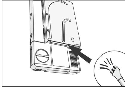
2. Verschmutzungen mit dem Staubsauger beseitigen. Dafür müssen Sie den Luftabfuhrfilter
