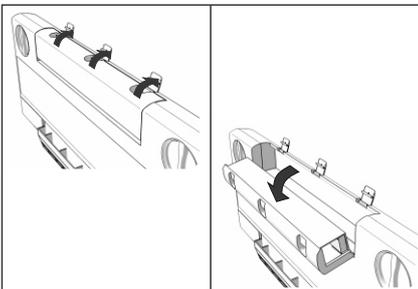
4. Die drei Verschlussklemmen an der Oberseite öffnen und das Filtergehäuse öffnen.
