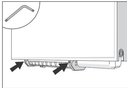
2. Die beiden Sicherungstifte mit einem Inbusschlüssel nach außen drehen.
