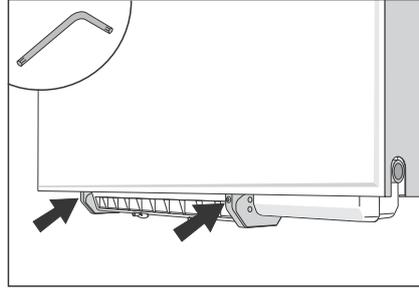
2. Die beiden Sicherungstifte mit einem Inbusschlüssel (nicht im Lieferumfang enthalten) nach außen drehen.
