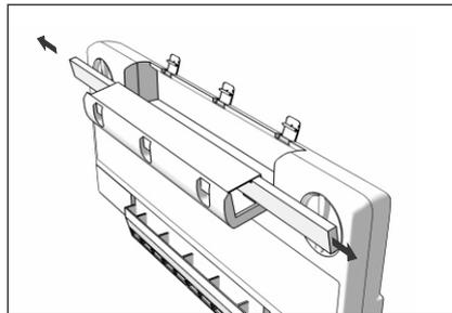
5. Die beiden verschmutzten Filterteile links und rechts aus dem Filtergehäuse herauschieben.
