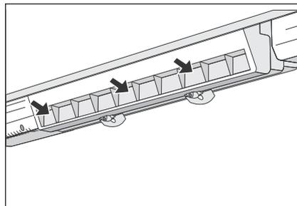
5. Die drei neuen Filterelemente in die Fächer einsetzen.
