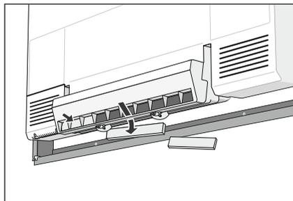
4. Die drei Filterelemente nach hinten schieben, damit sie sich lösen.
