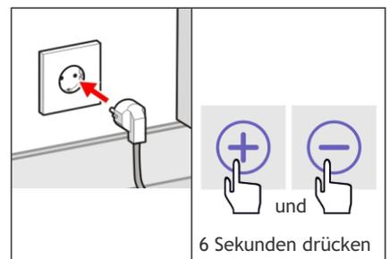
9. Den Stecker wieder in die Steckdose einstecken und den Stundenzähler des Filters zurücksetzen, indem Sie + und - auf dem Display gleichzeitig sechs Sekunden drücken. Die Meldung „Filter vervuild“ verschwindet nun.
