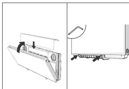
8. Die Abdeckung wieder befestigen und den Radiator schließen. Im Anschluss die beiden Sicherungstifte mit dem Inbusschlüssel festziehen.
