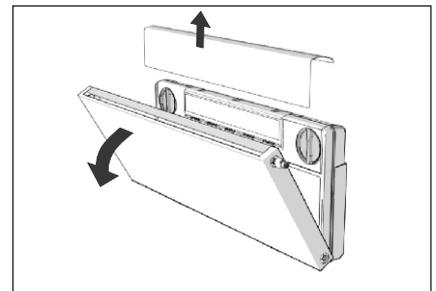
3. Den Radiator so weit wie möglich nach vorne kippen und die Abdeckung entfernen.
