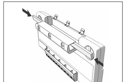
6. Die beiden neuen Filter vollständig in das Filtergehäuse einschieben, sodass sie nicht überstehen.
