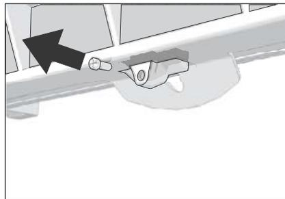
2. Die beiden Schrauben unter der Filterabdeckung herausdrehen.
