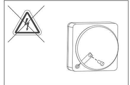
1. Den Strom im Sicherungskasten ausschalten und die Sicherungsschraube herausdrehen.
