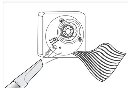
3. Bei leichter Verschmutzung: Schmutz und Ansammlungen mit einem weichen, fusselfreien Tuch oder einem Staubsauger entfernen.
