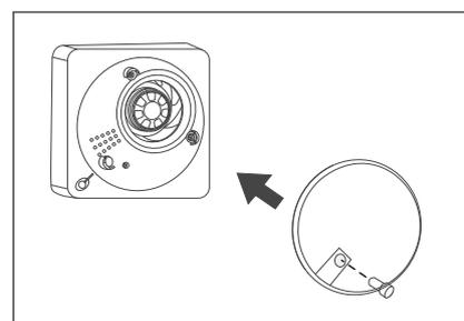
9. Die Abdeckung wiedereinsetzen und die Sicherungsschraube festziehen.
