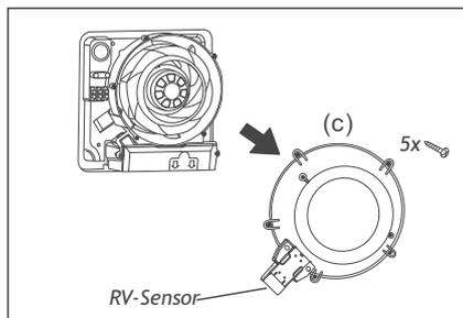
5. Den RV-Sensor (wenn vorhanden) entkoppeln und die fünf Schrauben des Kesseldeckels (c) herausdrehen.
