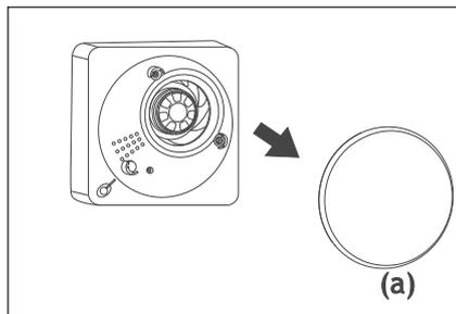
2. Die runde Abdeckung (a) durch Abziehen entfernen und den Ventilator auf Verschmutzungen kontrollieren.
