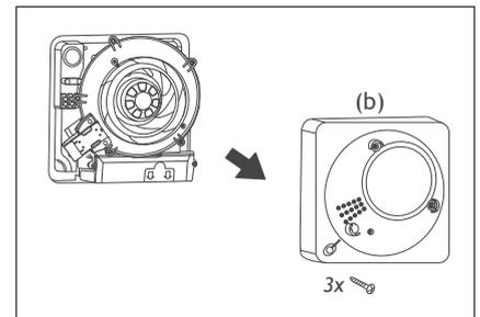
4. Bei starker Verschmutzung: die drei Schrauben des Innengehäuses (b) lösen und das Innengehäuse entfernen.
