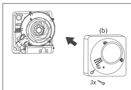
8. Das Innengehäuse (b) im ClimaRad Fan montieren. Alle Schrauben festziehen.
