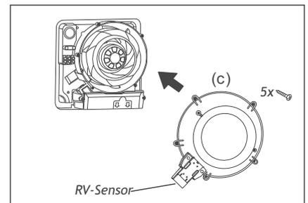
7. Den Deckel (c) nach der Reinigung montieren und den RV-Sensor (wenn vorhanden) wieder anschließen.
