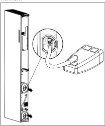
4. Die Kappen der beiden Luftkanäle entfernen. Die Eingänge der Kanäle mit einem trockenen Tuch oder mit dem Staubsauger reinigen. Auch das Insektennetz im oberen Luftkanal reinigen. Anschließend die Kappen wieder auf das Gerät setzen.
