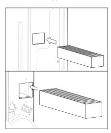
4. Die beiden verschmutzten Filter entfernen und den neuen Zufuhrfilter (unten) und Abfuhrfilter (oben) einsetzen.
