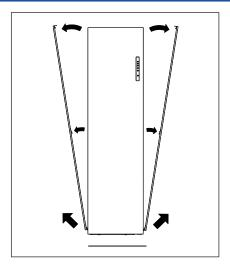
2. Entfernen Sie die beiden Schrauben an der oberen Abdeckung. Entfernen Sie dann eine der beiden Seitenpaneele des Gerätes.
