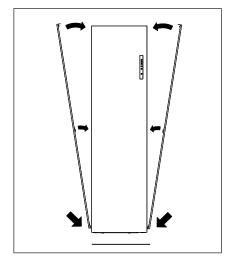
5. Die Seitenpaneele wieder zurücksetzen. Bringen Sie dann die beiden Schrauben an der oberen Abdeckung wieder an.
