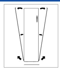
3. Entfernen Sie die beiden Schrauben an der oberen Abdeckung. Entfernen Sie dann eine der beiden Seitenpaneele des Gerätes.
