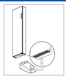
2. Das Insektennetz an der Unterseite des Units mit dem Staubsauger reinigen.
