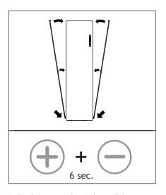
6. Die Seitenpaneele wieder zurücksetzen. Bringen Sie dann die beiden Schrauben an der oberen Abdeckung wieder an. Den Filterstundenzähler wieder zurücksetzen, indem Sie die obenstehende Tastenkombination 6 Sekunden lang eindrücken. Die Meldung "Filter verschmutzt" erlischt jetzt. Auf eine willkürliche Taste drücken, um den Service-Modus zu verlassen.
