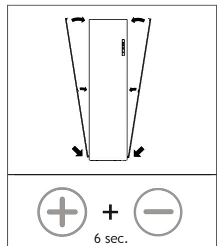
6. Die Seitenpaneele wieder zurücksetzen. Den Filterstundenzähler wieder zurücksetzen, indem Sie die obenstehende Tastenkombination 6 Sekunden lang eindrücken. Die Meldung „Filter verschmutzt“ erlischt jetzt. Auf eine willkürliche Taste drücken, um den Service-Modus zu verlassen.
