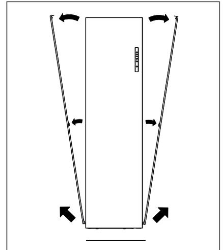
3. Eine der beiden Seitenpaneele des Gerätes entfernen.
