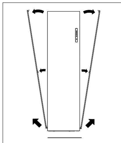
2. Eine der beiden Seitenpaneele des Gerätes entfernen.
