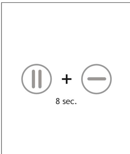
1. Schalten Sie Ihr Gerät in den Service-Modus, indem Sie die obenstehende Tastenkombination 8 Sekunden lang eindrücken. Alle LED-Leuchten brennen. 1 Minute warten, damit sich die Klappen öffnen können.
