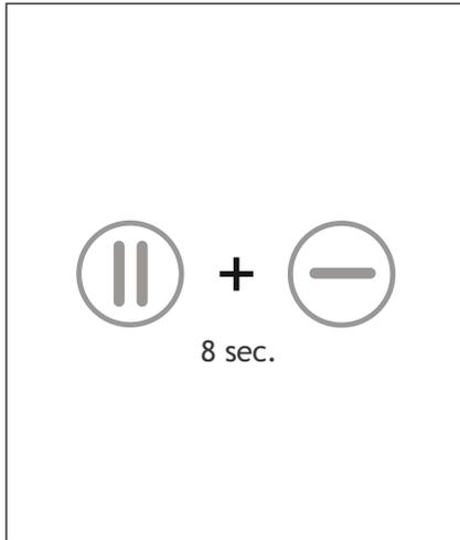
1. Schalten Sie Ihr Gerät in den Service-Modus, indem Sie die obenstehende Tastenkombination 8 Sekunden lang eindrücken. Alle LED-Leuchten brennen. 1 Minute warten, damit sich die Klappen schließen können.
