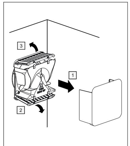
Im externen Raum das Gehäuse des Units entfernen und anschließend die beiden Lamellengitter. Das Unit mit einem trockenen Tuch oder mit dem Staubsauger reinigen. Anschließend die Lamellen und das Gehäuse wieder zurücksetzen.
