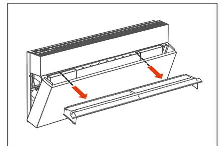
3. Entfernen Sie den Luftverteiler.
