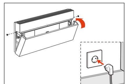
9. Klappen Sie das untere Gehäuse wieder zurück und befestigen Sie dieses mit den Schrauben. Stecken Sie anschließend den Stecker wieder in die Steckdose.
