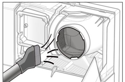
6. Verschmutzung aus beiden Kanälen mit dem Staubsauger oder einem weichen Tuch (kein Wasser verwenden) entfernen.
