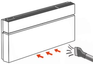
Die Luftabfuhrfilter befinden sich an der Unterseite des Gerätes. Reinigen Sie die Filter mit dem Staubsauger, wenn die Verschmutzung deutlich zu sehen ist. Dadurch bleibt der Luftdurchlass gewährleistet. Dabei ist es nicht erforderlich, die Luftabfuhrfilter herauszunehmen.
