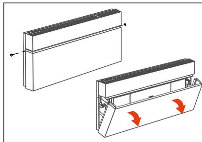
2. Schrauben Sie die Verriegelungsschrauben aus dem Gehäuse. Das untere Gehäuse klappt jetzt nach vorne.
