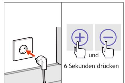
9. Schließen Sie das Gerät wieder an die Stromversorgung an und setzen Sie den Filterstundenzähler zurück (6 Sek. lang gleichzeitig auf + und - drücken). Die Meldung „Filter vervuild“ erlischt jetzt.
