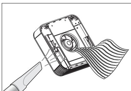
2. Den Ventilator mit einem trockenen, fusselfreien Tuch oder Staubsauger reinigen.
