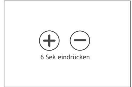
3. Nach dem Ersetzen den Stundenzähler des Filters zurücksetzen, indem Sie die Tasten + und - gleichzeitig sechs Sekunden lang gedrückt halten. Die Meldung „Filter vervuild“ verschwindet nun.
