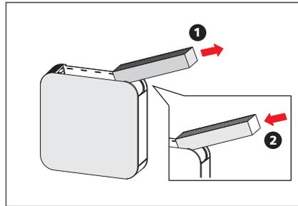
2. Den alten Filter entfernen und den neuen Filter in das Gerät schieben. Die Abdeckung wieder anbringen.
