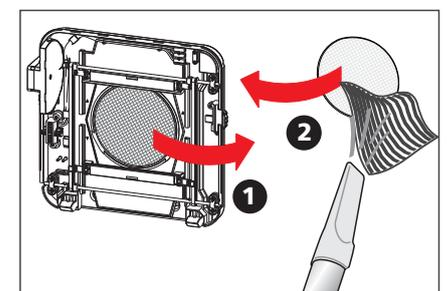
4. Das Insektengitter per Hand entfernen und mit einem trockenen, fusselfreien Tuch oder Staubsauger reinigen. Das Insektengitter und das Gerät nach der Reinigung wieder einsetzen und die Verriegelung auf der linken und rechten Seite nach unten schieben.
