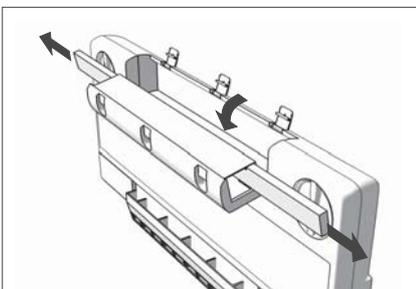
4. Die beiden verschmutzten Filterteile an den Seiten aus dem Filtergehäuse herauschieben.
