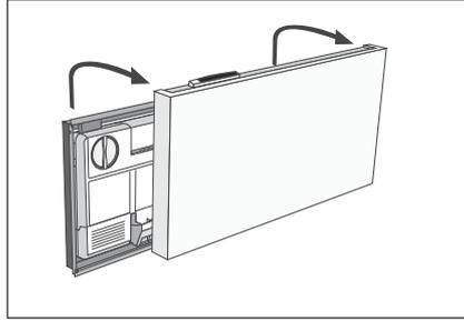
2. Die Abdeckung der Sensa durch Anheben entfernen. nicht herausnehmen.
