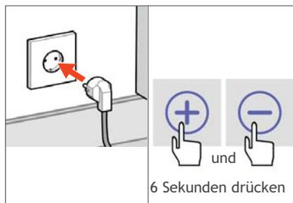
8. Den Stecker wieder in die Steckdose einstecken und den Stundenzähler des Filters zurücksetzen, indem Sie + und - auf dem Display gleichzeitig sechs Sekunden drücken. Die Meldung „Filter vervuild“ verschwindet nun.
