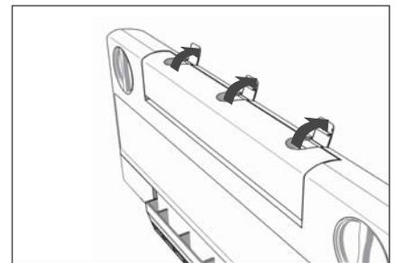
3. Die drei Verschlussklappen an der Oberseite des Geräts öffnen und das Filtergehäuse nach vorne kippen.
