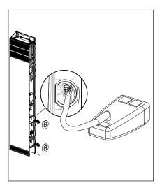
4. Die Kappen der beiden Luftkanäle entfernen. Das Insektennetz im oberen Luftkanal mit dem Staubsauger reinigen. Die Eingänge beider Luftkanäle mit einem trockenen Tuch oder mit dem Staubsauger reinigen.
