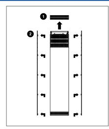
1. Entfernen Sie zunächst das obere Gitter des Geräts (1). Dann die rechte und linke Seitenpaneele (2). Das interne Bedienfeld ist auf der rechten Seite angebracht.
