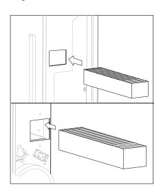
4. Die beiden verschmutzten Filter entfernen und den neuen Zufuhrfilter (unten) und Abfuhrfilter (oben) einsetzen.
