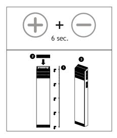
6. Setzen Sie den Filterstundenzähler zurück, indem Sie die obige Tastenkombination 6 Sekunden lang drücken. Die Meldung "Filter verschmutzt" verschwindet.
