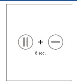
2. Schalten Sie Ihr Gerät in den Service-Modus, indem Sie die obenstehende Tastenkombination 8 Sekunden lang eindrücken. Alle LED-Leuchten brennen. 1 Minute warten, damit sich die Klappen öffnen können.
