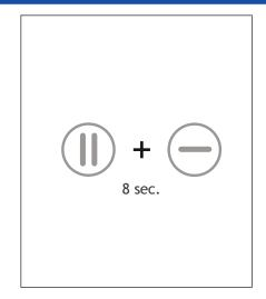
2. Schalten Sie Ihr Gerät in den Service-Modus, indem Sie die obenstehende Tastenkombination 8 Sekunden lang eindrücken. Alle LED-Leuchten brennen. 1 Minute warten, damit sich die Klappen schließen können.
