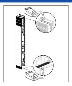
3. Das Insektennetz an der Oberund Unterseite des Units mit dem Staubsauger reinigen.
