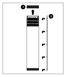
1. Entfernen Sie zunächst das obere Gitter des Geräts (1). Dann die rechte Seitenpaneele (2). Hier ist das interne Bedienfeld angebracht.
