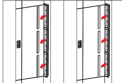
2. Die drei Filter aus dem Einschub entfernen.
