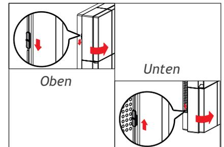
3. Der obere Verschluss am linken Seite des ClimaRads nach unten schieben und der untere Verschluss nach oben schieben. Beide Klappen öffnen, indem Sie diese in Ihre Richtung ziehen.
