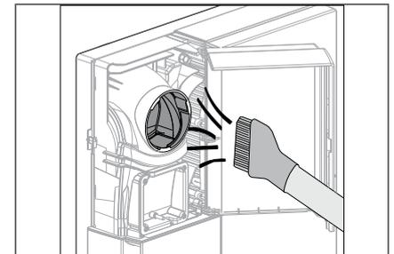
5. Mit einem Staubsauger oder einem weichen Tuch den Schmutz aus beiden Kanälen entfernen (kein Wasser verwenden).
