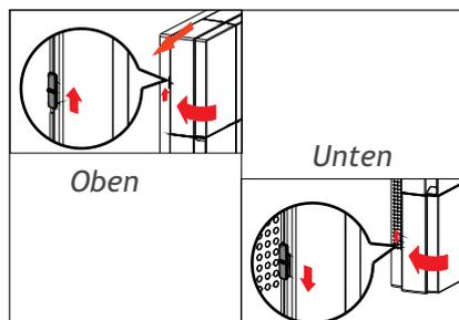
7. Die Klappen an der linken und der rechten Seite des Geräts schließen und die beiden Sicherungsschrauben wieder nach außen drehen.
