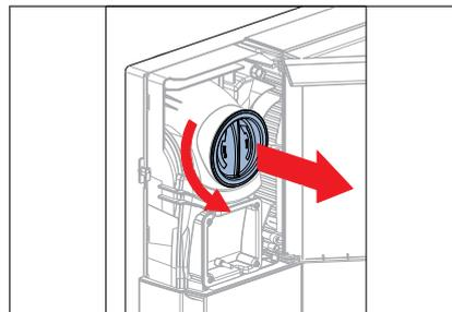
4. Die beiden blauen Stopfen eine Umdrehung gegen den Uhrzeigersinn drehen und entfernen.
