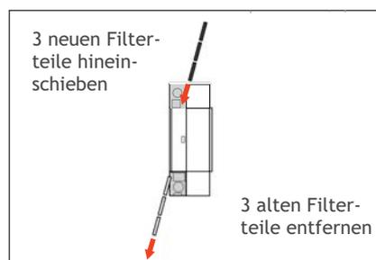
5. Die drei neuen Filterteile an der oberen Seite in das Gerät hineinschieben. Die alten Filterteile kommen dadurch automatisch unten heraus.
