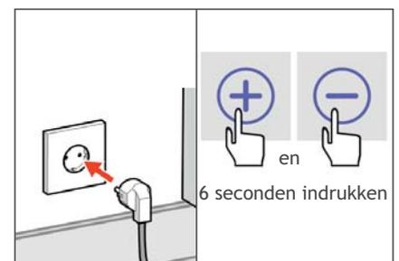
14. Den Stecker wieder in die Steckdose einstecken und den Stundenzähler des Filters zurücksetzen, indem Sie + und - auf dem Display gleichzeitig sechs Sekunden drücken. Die Meldung „Filter vervuild“ verschwindet nun.
