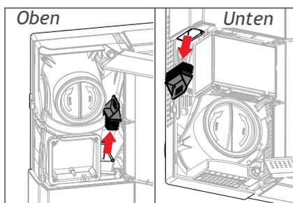
4. Die beiden Filterstopfen oben und unten entfernen.
