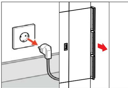
1. Den Stecker aus der Steckdose herausziehen und den Filtereinschub an der rechten Seite des ClimaRad nach vorne ziehen.
