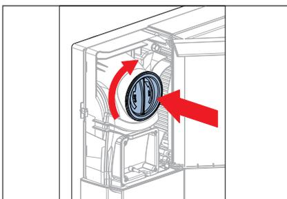
6. Die beiden blauen Filterstopfen wieder vollständig einsetzen und festdrehen, damit das Gerät ordnungsgemäß funktioniert.
