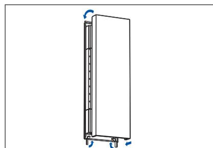
8. Die Abdeckung wiedereinsetzen und die Verriegelungshaken schließen (an der Unterseite des Gehäuses).
