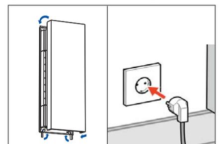
8. Die Abdeckung wiedereinsetzen und die Verriegelungshaken schließen und den Stecker wieder in die Steckdose einstecken.
