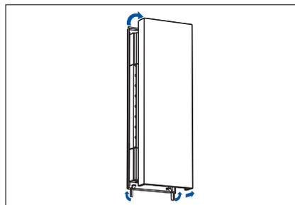
2. Die beiden Verriegelungshaken (an der Unterseite) öffnen. Die Abdeckung der Sensa V2X durch Anheben entfernen.
