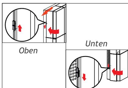
7. Die Klappen oben und unten an der rechten Seite des Geräts schließen und die beiden Sicherungsschrauben wieder zurück schieben.
