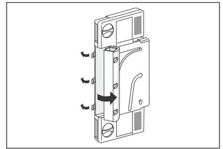
3. Die drei Verschlussklappen an der linken Seite des Geräts öffnen und das Filtergehäuse nach vorne kippen.
