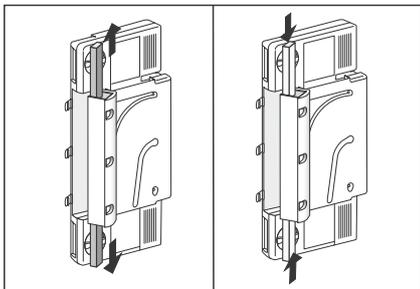
4. Die beiden verschmutzten Filterteile aus dem Filtergehäuse herauschieben und zwei neue Filterteile vollständig hineinschieben.
