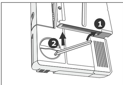
4. Den neuen Filter mit der rechten Seite zuerst in die Öffnung einsetzen. Danach die linke Seite des Filters in die Öffnung hineinschieben.
