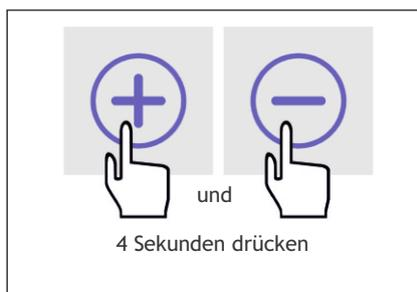
8. Den Stundenzähler des Filters zurücksetzen, indem Sie + und - auf dem Display gleichzeitig vier Sekunden drücken. Die Meldung „Filter vervuild“ verschwindet nun.
