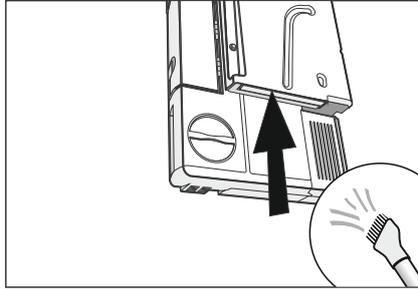
2. Verschmutzungen mit dem Staubsauger beseitigen. Dafür müssen Sie den Luftabfuhrfilter nicht herausnehmen.
