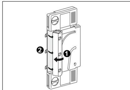
5. Das Filtergehäuse verschieben und mit den drei Verschlussklappen befestigen.
