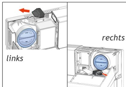
5. Die beiden Filterstopfen links und rechts entfernen.
