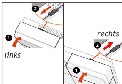
8. Die Klappen an der linken und der rechten Seite des Geräts schließen und die beiden Sicherungsschrauben wieder nach außen drehen.
