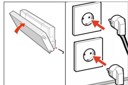
9. Den Radiator entriegeln und wieder zurückkippen. Den Stecker wieder in die Steckdose einstecken und die Sicherungsschrauben wieder festdrehen.
