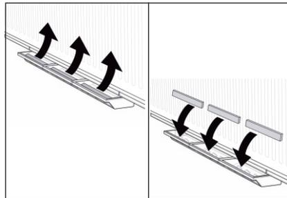
2. Die drei Filter aus dem Einschub entfernen.
