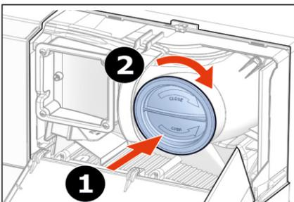
7. Die beiden blauen Filterstopfen wieder vollständig einsetzen und festdrehen, damit das Gerät ordnungsgemäß funktioniert.
