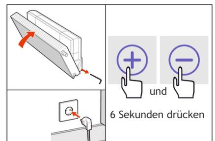
9. Den Radiator entriegeln und wieder zurückkippen. Den Stecker wieder in die Steckdose einstecken und den Stundenzähler des Filters zurücksetzen, indem Sie + und - auf dem Display gleichzeitig sechs Sekunden drücken. Die Meldung "Filter vervuild" verschwindet nun. Die Sicherungsschrauben wieder eindrehen.
