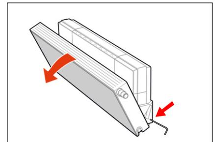
3. Den Radiator kippen und gegebenenfalls mit einem Inbusschlüssel oder Schraubendreher verriegeln.
