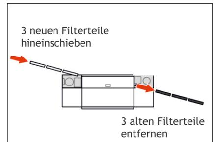
6. Die drei neuen Filterteile an der linken Seite in das Gerät hineinschieben. Die alten Filterteile kommen dadurch automatisch an der rechten Seite heraus.
