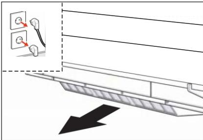
1. Ziehen Sie den Stecker der Lüftungs-Einheit und des elektrischen Radiators aus der Steckdose und ziehen Sie die Filterschublade an der Unterseite
